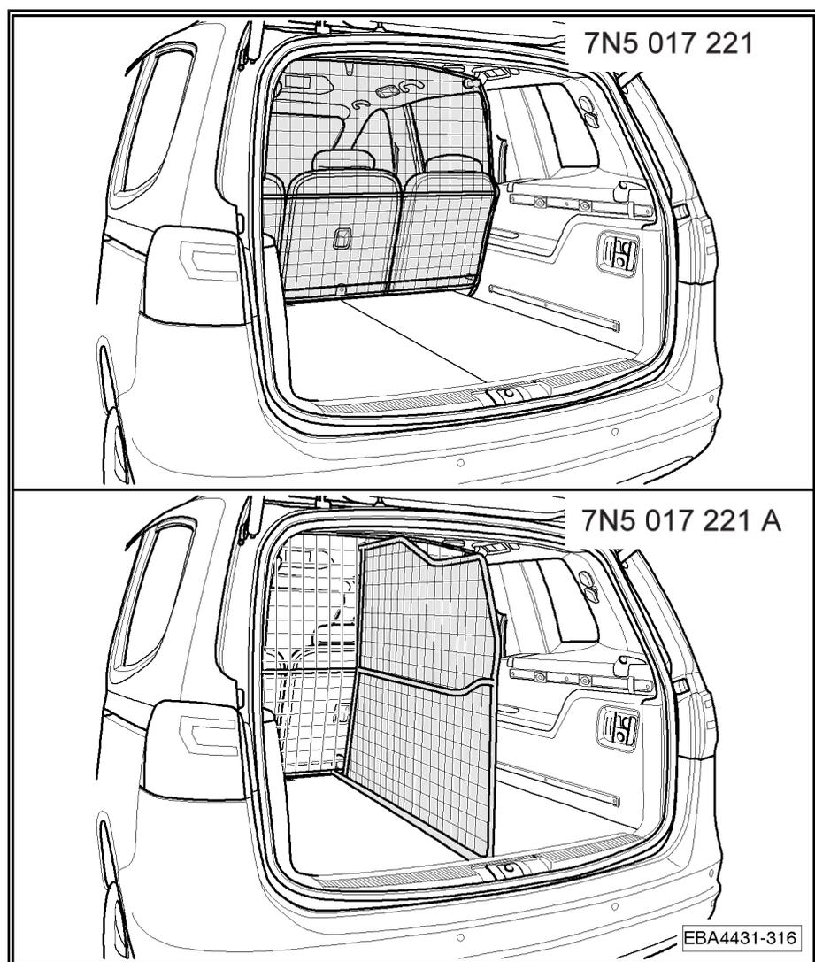
Montaggio della griglia di separazione 7N5 017 221 ⇒ **Pag. 36.**
